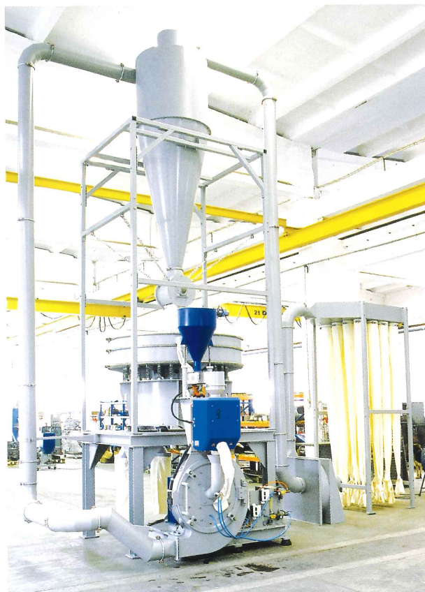
PM 500、スクリーン装置及び 吸引システム込みの粉碎システム
