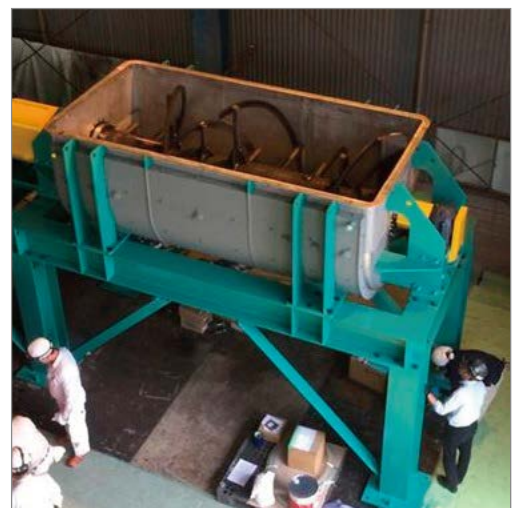
RMM-6000- ジャケット付 製作中 作業員の大きさと比較して下さい
