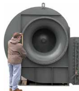
鉄鉱石ペレット除塵用ファン
