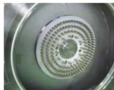
セラミックス溶射のディスクにセラミックスピン
