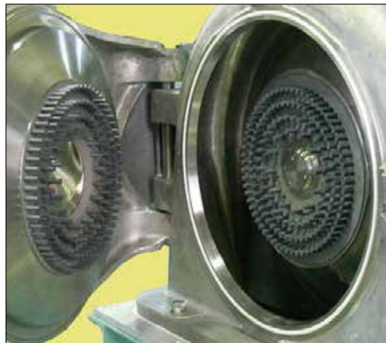
400Z 超硬ピン + 超硬溶射ディスク
