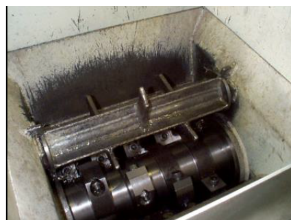
HH型 爪で引き千切るタイプ外観と内部
