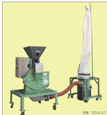
粉碎品捕集缶別置きタイプ 粉碎機と粉碎品回収部を別にした。 原料供給位置を低く出来ます。
