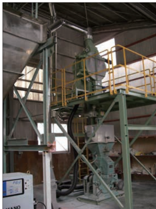
寒天工場で稼働中の マキノ式粉碎機CI-45+MS-90-NF
