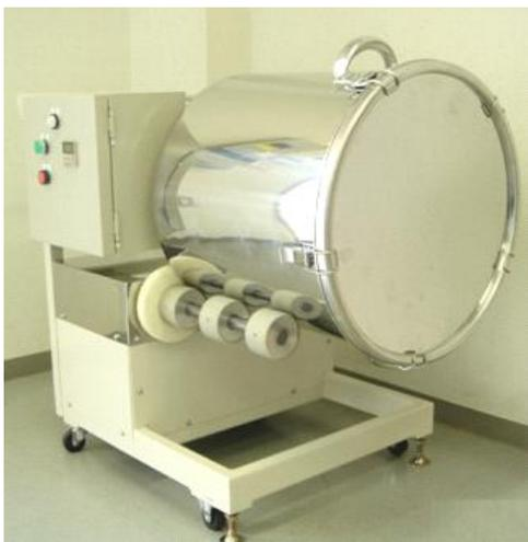
(市販のステンレス容器に仕込まれた各種混合材料は、容器が傾斜回転することと、容器内に設けられた攪拌リフターの作用により、ソフトに混合される。容器の回転数、攪拌リフターの形状及び混合時間により希望する混合物を得ることが出来る。容器は簡単に取外し可能で、洗浄出来る。)
